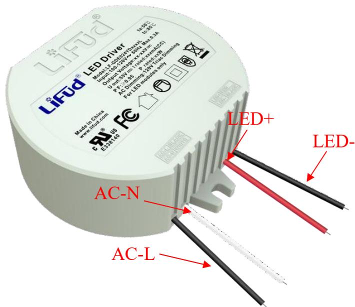
**Cable de entrada:** UL1015 No.18 cable multi-soporte, negro AC-L y blanco AC-N, longitud total de 300mm ± 10mm 10mm, expuesto 250mm ± 10mm, cola de estaño de inmersión 10mm ± 2mm
